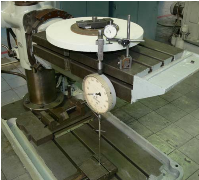
Рис. 6. Экспериментальная установка для исследования деформации изгиба шлифовальных кругов
