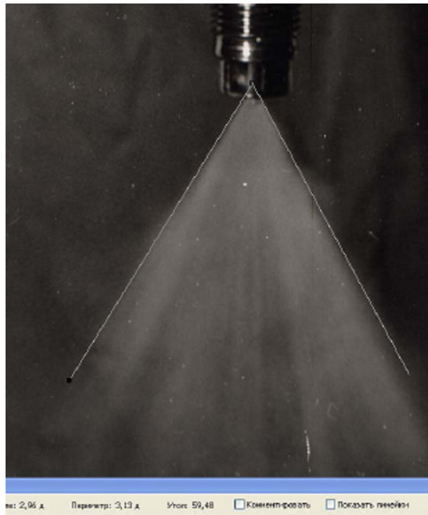
Рис.8. Распыл топлива штифтовой форсункой при давлении 80 МПа.
