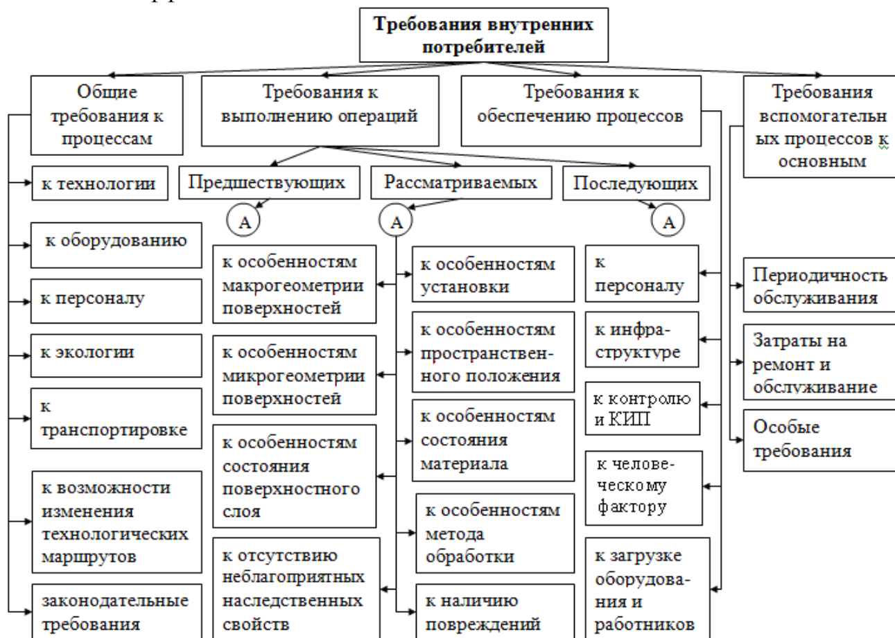
Рисунок 5 – Классификатор требований внутренних потребителей к качеству технологического процесса
