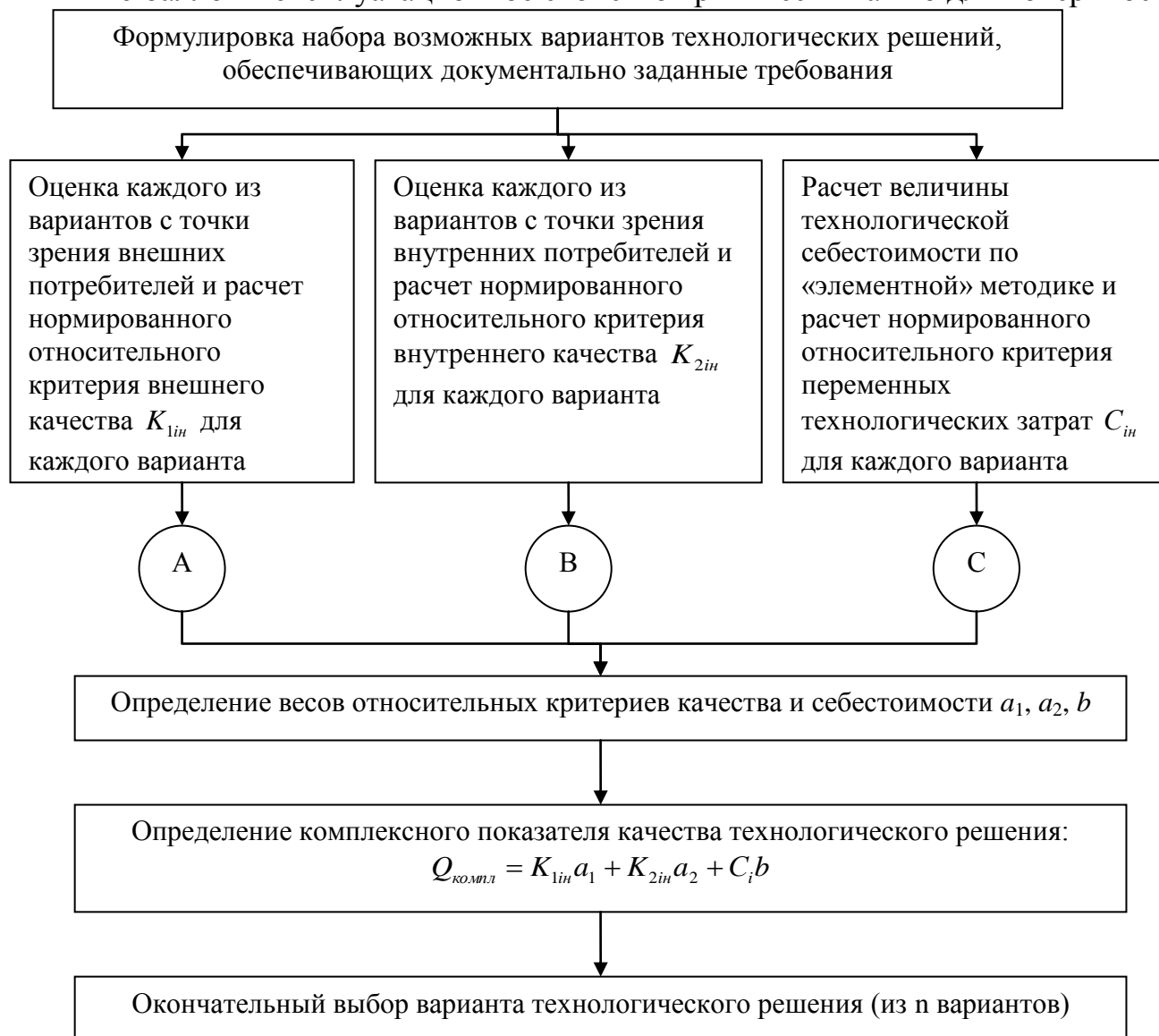
Рисунок 6 – Алгоритм выбора оптимального варианта технологического процесса по комплексному критерию качества
