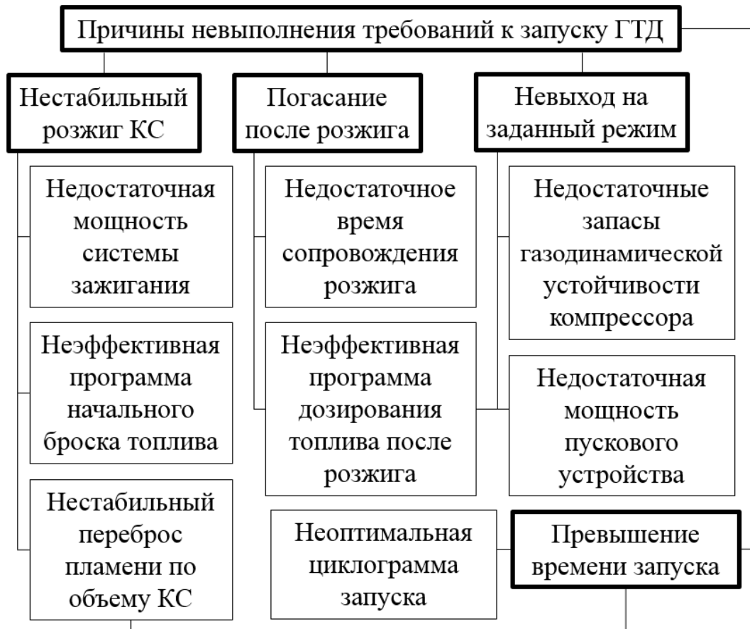
Рисунок 1 – Причины, обуславливающие невыполнение требований, предъявляемых к запуску газотурбинного двигателя
