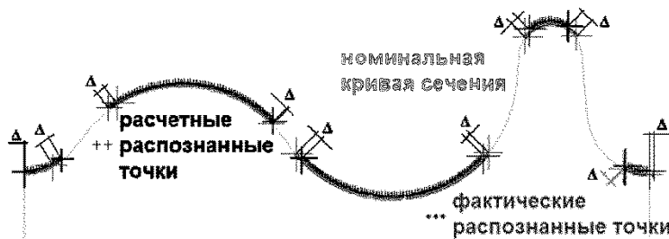
Рисунок 5 - Пример совмещения теоретического и оцифрованного изображений сечений образца № 2 в плоскости XZ ( F_x=120 , F_z=0 , \beta=0^\circ ).
