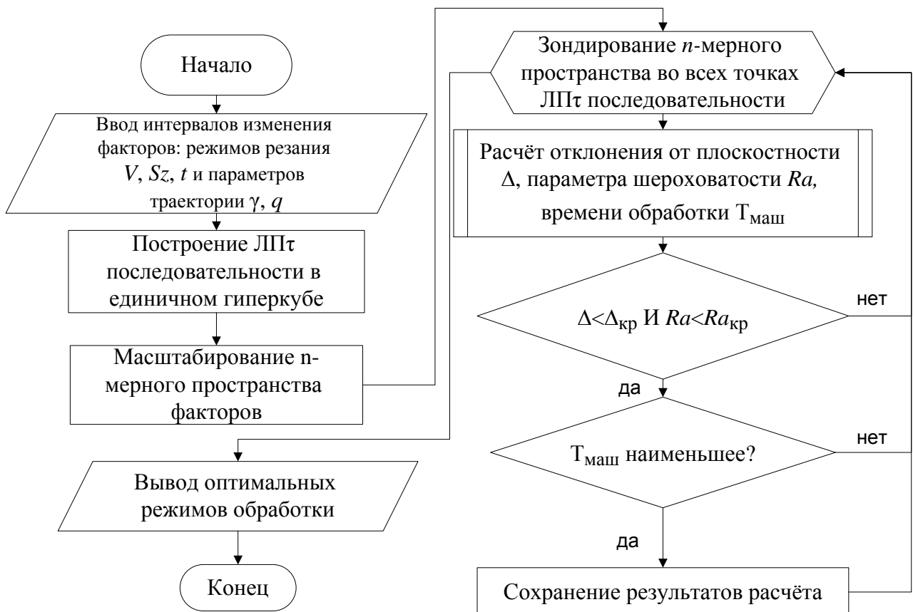
Рисунок 9 – Алгоритм поиска оптимальных значений режимов резания и параметров траектории
