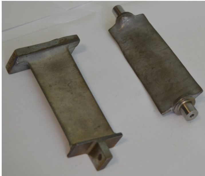
Рисунок 1 – Лопатки турбореактивного двигателя из титановых сплавов
